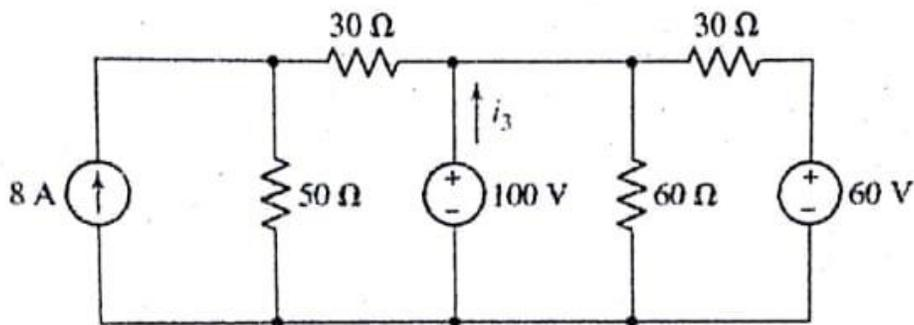
2.0 Halle el Equivalente Thévenin visto desde los terminales a-b, e indique que resistencia conectada en paralelo recibirá la máxima potencia posible.
