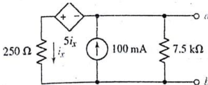
3.0 Utilizando el método de transformación de fuentes, Convierta el circuito de la figura en una sola fuente de corriente en paralelo con una resistencia.
