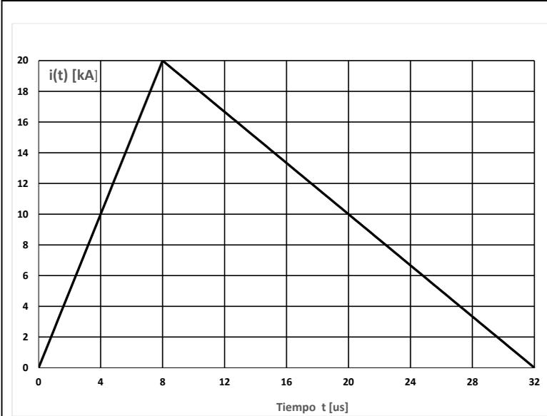
Un impulso de corriente tipo rayo denominado onda 8 / 20 [us], con valor pico de 20 [kA] se podría modelar como se muestra a continuación. Asuma que la carga inicial del elemento por el cual circula la corriente es  $q(0 \text{ us}) = 0 \text{ [C]}$ .
