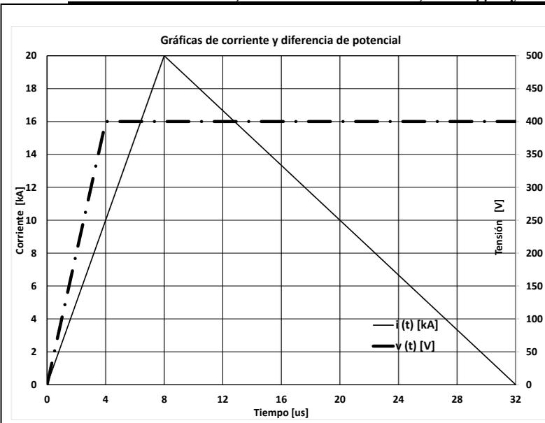
La línea punteada representa la diferencia de potencial entre los terminales de un dispositivo de protección contra sobretensiones (DPS), cuando a través de este circula la corriente del punto 1.
